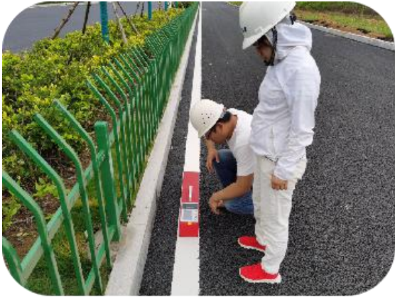
图 154 标线逆反射系数检测
