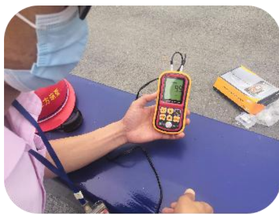
图 152 立柱壁厚检测
