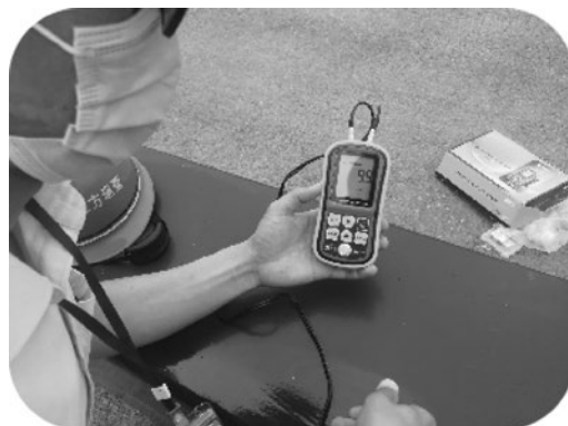
图 8.2.4-2 立柱壁厚检测
