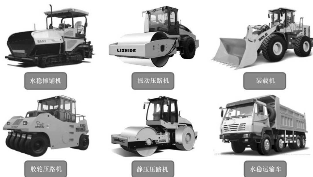
图 5.2.1 水泥稳定碎石施工机械设备图例
