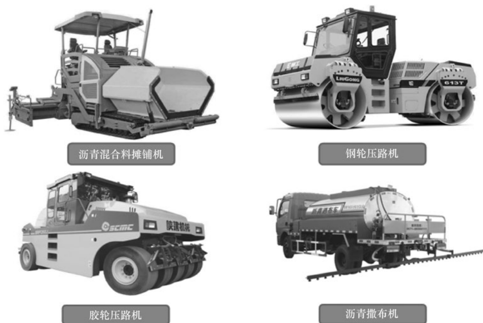
图 5.3.1-1 热拌沥青混合料面层施工机械设备图例
