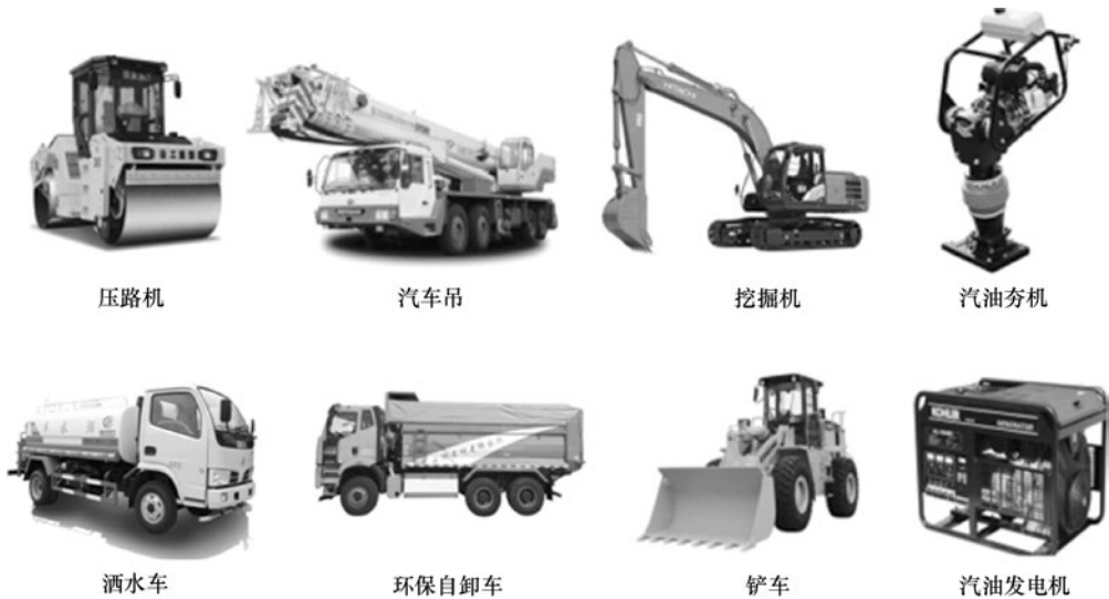
图 6.1.2 施工准备阶段施工机械设备图例
