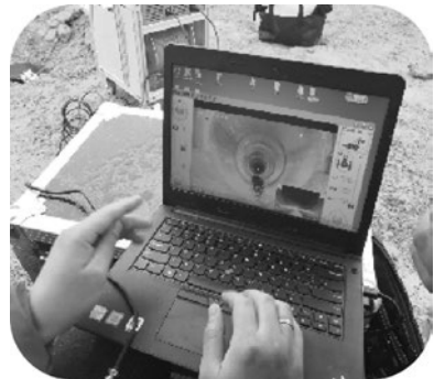
图 6.2.8-3 CCTV 管道检测
